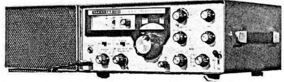
Ein Gerät, das in kurzer Zeit zu einem Bestseller geworden ist und das sich sowohl im Stationsbetrieb wie auch im Mobileinsatz bestens bewährt hat. Es besitzt eingebauten 100 kHz Calibrator, VOX-Automatik, Störbegrenzer und Anschluß für den Betrieb eines 2m Transverters.
