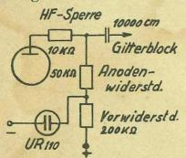
die Abbildung, vom "kalten" Ende des 50 000 Ohm Anodenwiderstandes nach Minus. Durch einen 200 000 Ohm Vorwiderstand wird die Audionanodenspannung reduziert. Dies ist notwendig, da sonst die Glimmlampe überlastet würde. Wem ein mA-Meter mit einem Meßbereich von 0—1 mA zur Verfügung steht, der kann durch Verändern der Größe des Vorwiderstandes den günstigsten Glimm-
