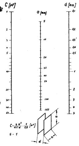
Kapazität von quadratischen Plattenkondensatoren mit Luft die Lektrikum "
