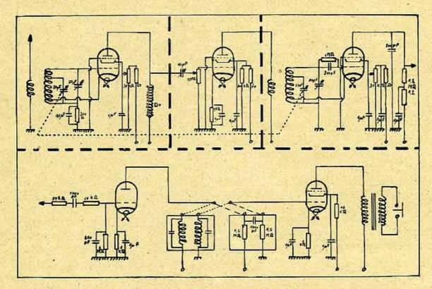
Für die Abstimmelemente im NF-Teil wurden kleine, mit geschlossenem Kern ausgerüstete Drosseln verwendet. Der Kern wurde durch Entfernen des Querstückes zu einem "U" umgebildet, und dann die beiden U-Stücke, die jeweils die Spule tragen, mit ihren Oeffnungen auf das benötigte Maß von ca. 5 mm zusammengeführt. Zur Erzielung der gewünschten Resonanz wurden parallel zu den nunmehr als Spulen arbeitenden, ursprünglichen Drosseln Blocks gelegt; zweckmäßige Werte liegen bei ca. 50 000 pF.
