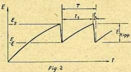
mittels Kopfhörer abhören. Das Spannungs-Zeit-Diagramm eines solchen Vorganges gibt Fig. 2 wieder. Im ersten Ast der Kurve lädt sich C auf, zündet bei Ez und entlädt sich in kurzer Zeit auf E1. Danach beginnt Neuaufladung in der Zeit t, und zwar widerum bis Ez; hierauf Entladung in der Zeit t2.
